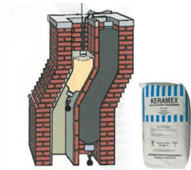
Fig. 1 Rehabilitering av skorstein med Keramex.
